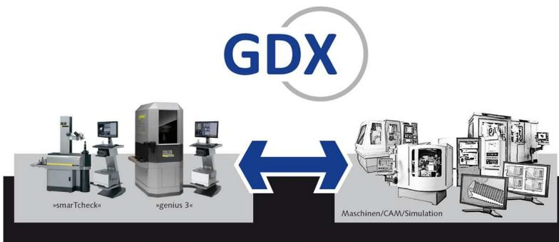
Dank der einheitlichen Datenstruktur aus GDX können Programmiersoftware, Maschinen und Messtechnik – hier von Zoller – in einem einheitlichen Format kommunizieren. (Quelle: Zoller)
