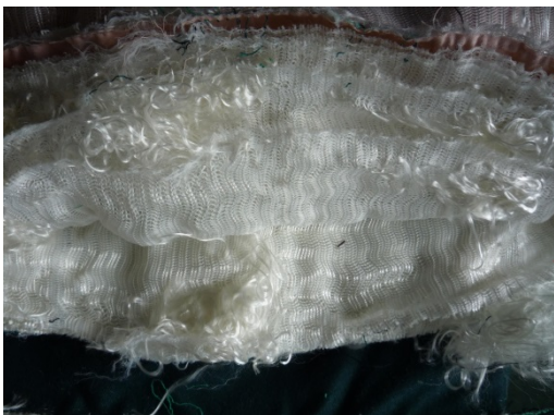
Abbildung 37: Saum eines Beinlings, in dem alle Schussfäden zum Saum nach unten gerutscht sind
