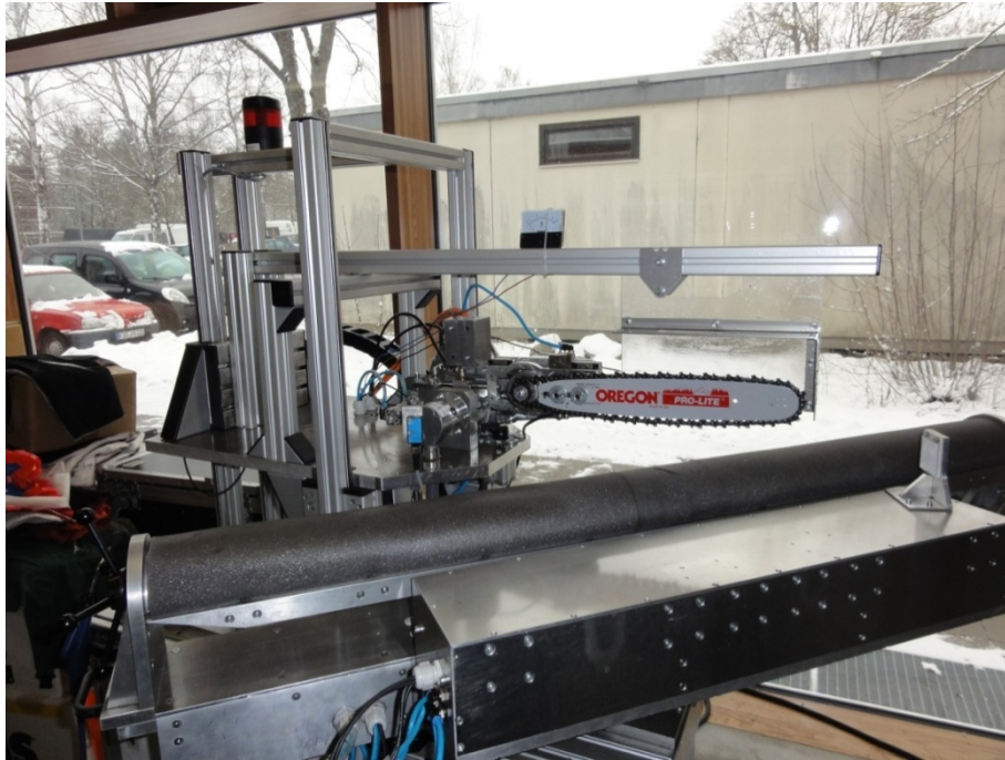
Abbildung 4: Höhenverstellbarer Prüftisch mit Sägeeinheit und Aufspannvorrichtung
