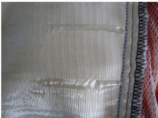
Abbildung 35: Fadenverschiebung in einem Beinling der Fa. HF-Forstwirtschaft
