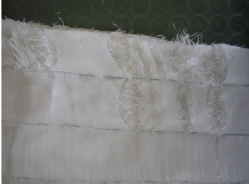
Abbildung 36: Längs versteppte Einlage mit herausgezogenen Schussfäden
