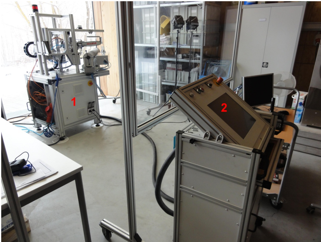
Abbildung 2: Prüfstand (1) nach DIN 381-1 mit Steuerkonsole (2)
