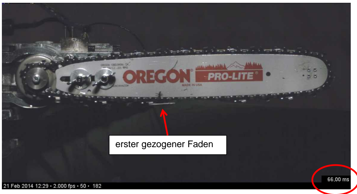
Abbildung 92: Bild aus High-Speed-Film beim Auftreffen der Sägekette (Hose 1)
