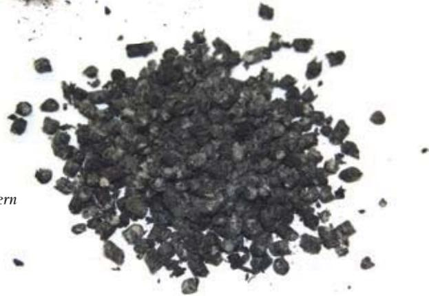
Abb. 4b: Pellets aus Altreifenfasern
