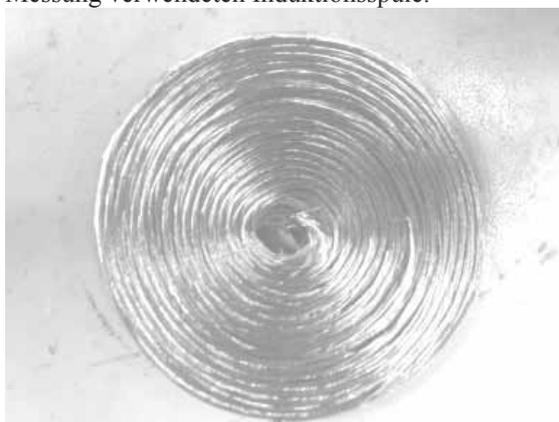
**Abbildung 4.** Typische für die Messung verwendete Induktionsspule.
