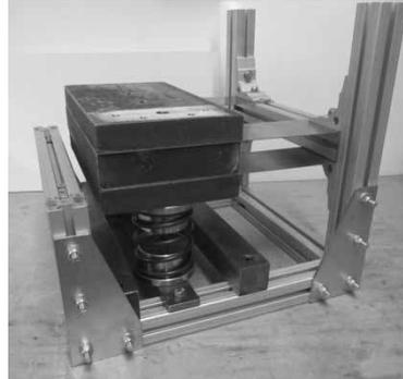
Abbildung 3: Dummy zur Nachbildung der Eingangsimpedanz eines menschlichen Körpers (98 kg) bei Vertikalschwingungen
