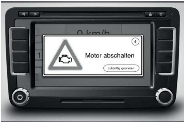
**Abbildung 8: Überlagerte Handlungsempfehlung bei Stillstand des Fahrzeuges bei eingeschaltetem Motor länger einer Minute**
