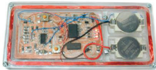
Abbildung 7: Versuchsaufbau zum Auslesen und Klonen eines 125KHz Read-Only Transponders [15]
