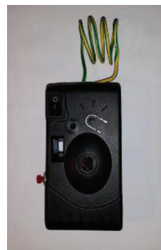
Abbildung 6: RFID Zapper, gebaut aus einer Kamera [17]
